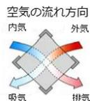
排気する空気から熱と湿気を給気する空気に戻すことにより換気による熱のロスを軽減する。
