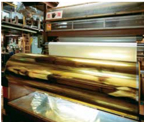
▲箔を被転写物に接着する「接着層塗布」の工程。ベースとなるフィルム に黄色の染料を塗布しておくことで、ゴールドの質感に。
