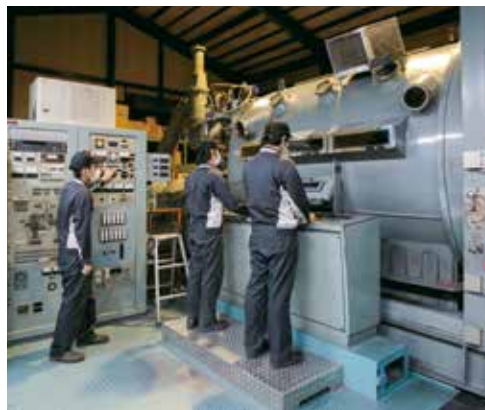
▲「真空蒸着機」。蒸発させたアルミを、約500Å(=0.05μm)の厚みで フィルムに密着させる。
