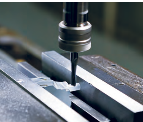
▲樹脂の特性に合わせて機械を使い分けることで、熱膨張率の高い素材でも加工公差を小さくすることができます。
