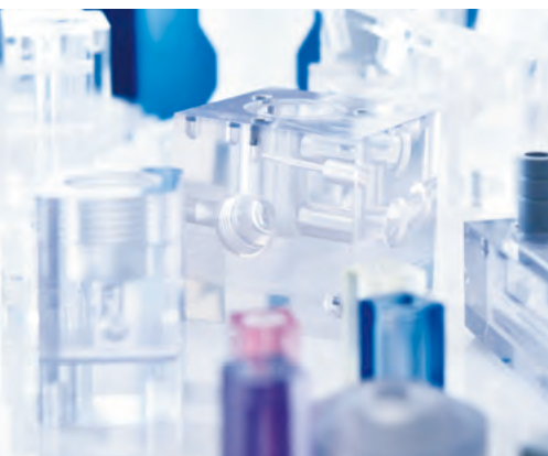
▲樹脂は通常、削ると白く濁ってしまうが、京都樹脂精工では精密な加工技術と研磨によって透明度を維持している。
