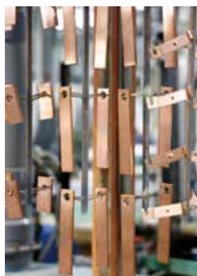
手動めっきラインから取り出した銅めっき。光沢や膜厚にムラがなく、均一な色調に仕上げるには熟練の技が必要だ。
