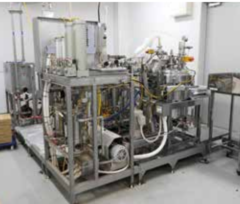
▲含浸設備を使用した菓子は第二工場で製造。クッキーやサブレなど、ぼろろ以外にも多様な菓子に対応している。
