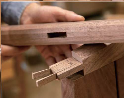
椅子の座面と脚の接合部。枘を通すための穴を開いており、はめ込んだ後に外側から楔を打ち込むことができる。楔によって外側が広がるため、脚は抜けなくなる。
