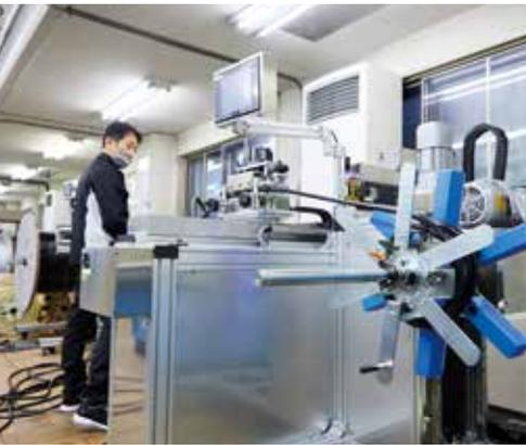
▲「ケーブル巻取切断機」はケーブルの測長と巻き取り、切断を一台で行うことができる。
