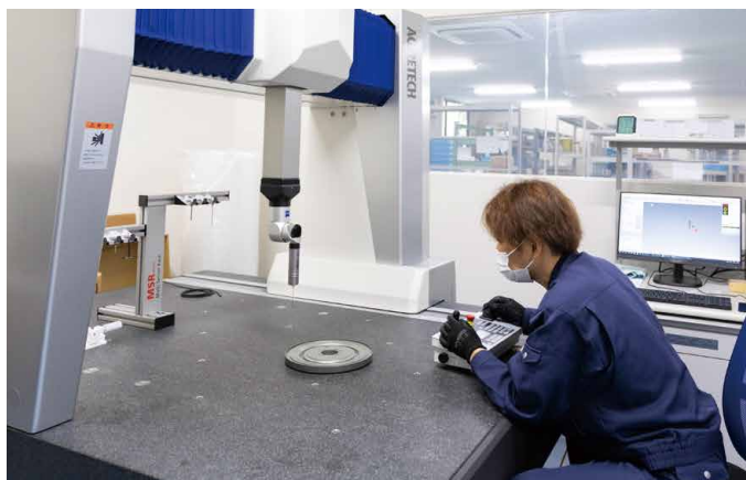
▲三次元測定機で検査を行う技術者。高精度な最新検査機器を用い、山中精工ならではの品質を担保している。
