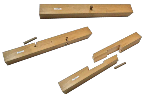
伝統的な手法で作られる継手仕口。修復・修理工事では、可能な限り元の木材を生かし、傷んだ部分だけを継手仕口によって新材に入れ替える。
